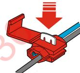
4. Задавите металлическую часть «зажим» в тело провода, не повредив медную жилу кабеля.
