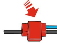
5. Зафиксируйте «зажим» сверху пластиковым изолятором до щелчка.
